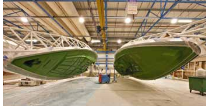
Injection deck / Pont en injection
